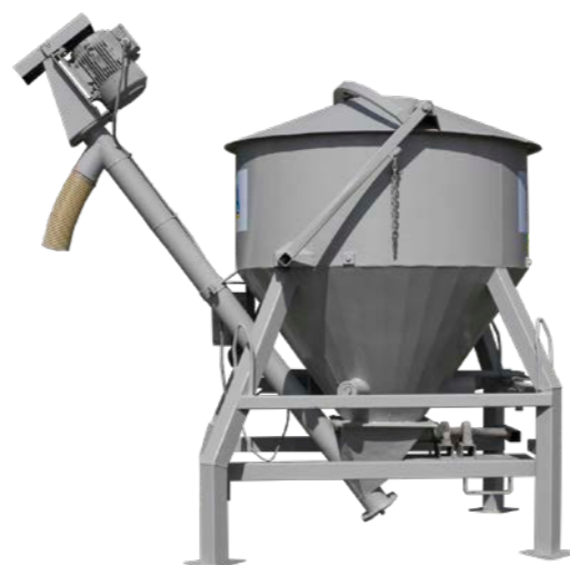
ST5 Storsäcksbehållare med skruvficka. Rymmer cirka två ton.
