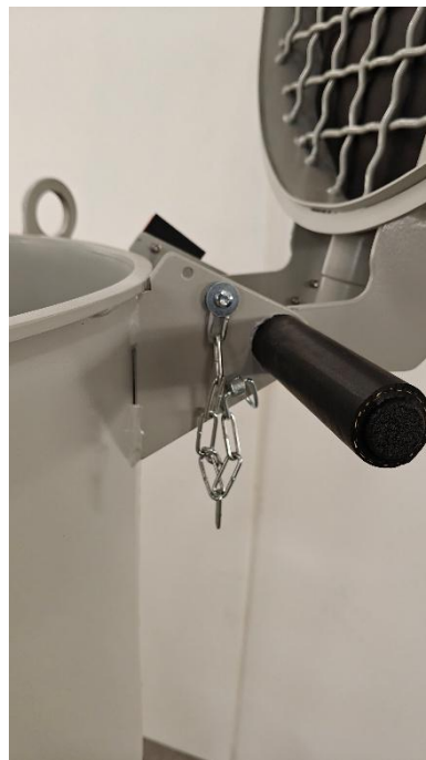
Bild 2. Locket öppet och splinten fastlåst. Se även till att elen är frångkopplad. Nu kan blandarkaret rengöras!
