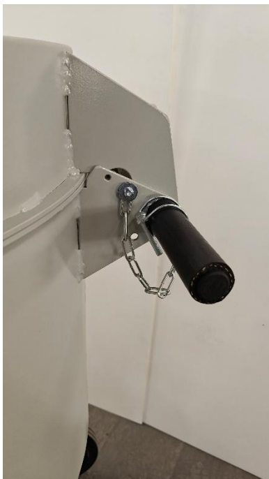
Bild. 1 Locket stängt och splinten fastlåst. Blandaren kan nu lyftas med stropopar!
